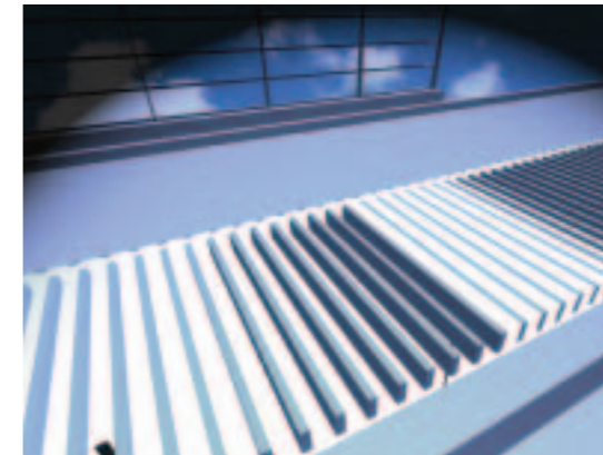
Principskitse, aften. Lysspalte set oppefra. Kunstlys ses igennem lamelriste. Lysspalten medvirker til en god lysfordeling, stor identitet og skaber sammenhæng mellem bro- og tunneldesign.
