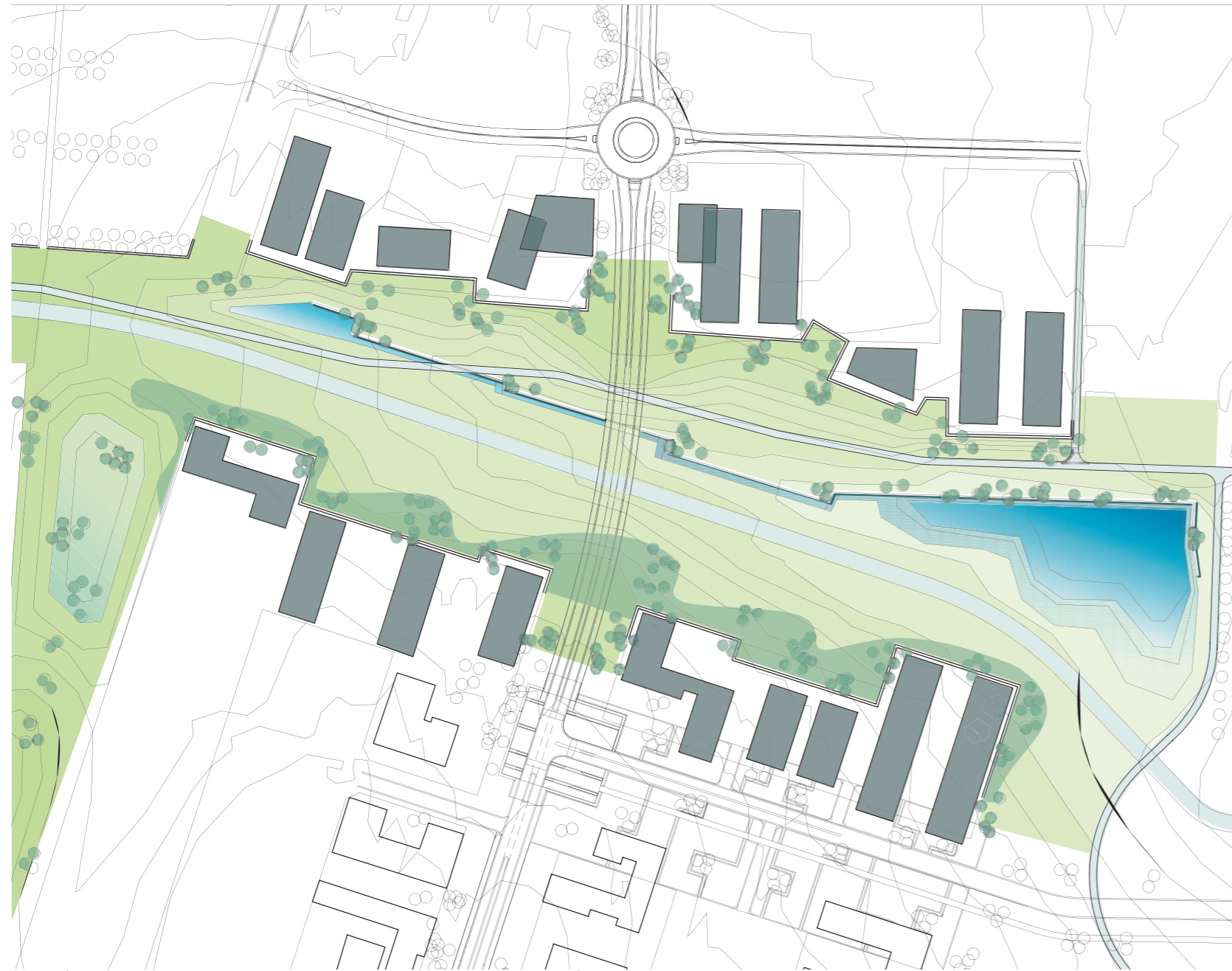
Kanalen fremtræder tydeligt i længderetning. Regnvandsbassinene i systemets ender er blødt formet
